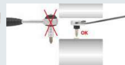
Embouts : hauteur 28 mm (au lieu de 58 mm avec un porte-embout et un cliquet classique)
