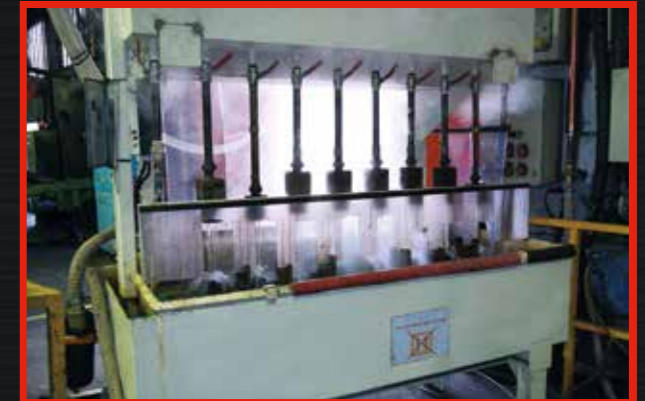
OPÉRATION DE TREMPE THERMISCHE HARDING
