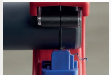
Zelfs korte stukken vanaf slechts ca. 10 mm kunnen worden afgeknipt. De gedraaide spaan ontstaat bij het afschuiven.
