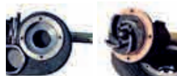
Turbine in gegoten staal (op pomp 7 m)
